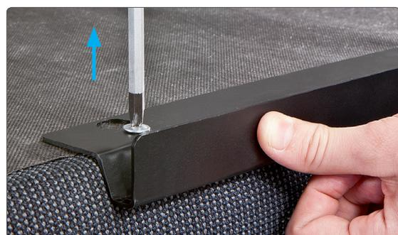
Drehen Sie Ihr Möbel vorsichtig um, heben es (Öffnung unten) an und hängen es in den Verbinder ein. Auf einem ebenen Untergrund ist nun eine stabile Verbindung gewährleistet.
